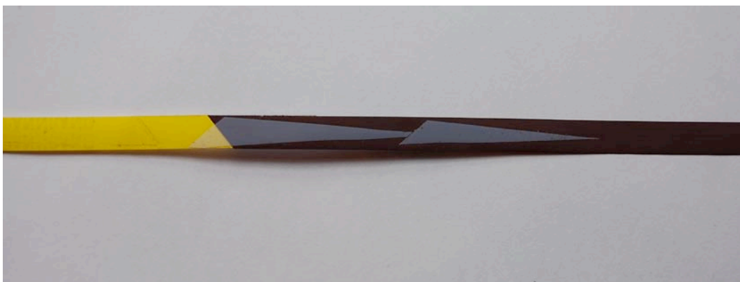
Abb. 11: Keilförmig zugeschnittene, an der Schichtseite angebrachte Klebebandstücke zur Erzielung von Spezialeffekten
