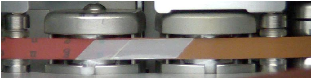
Abb. 11: Drehung der Schichtlage zur Erzielung eines gedämpften, mystischen Klanges
