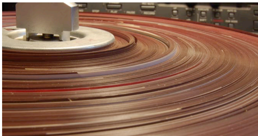
Abb. 4) Typisches Band der Sammlung Oskar Sala: Lockerer, stufiger Wickel, unzählige Schnitte und Klebestellen
